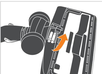
**Remplacement des piles du suceur de plancher CleanLight** (peut varier selon les modèles)
