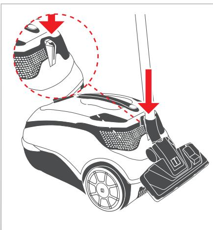
Utilisez le support situé à l'arrière de l'appareil pour fixer le flexible d'aspiration à l'appareil.
