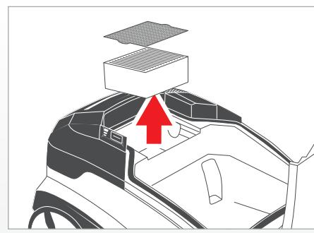
**!** K čištění nepoužívejte kartáč ani pomocné materiály, které by mohly poškodit lamely filtru. Před opětovným vložením do přístroje musí být filtry úplně suché.
