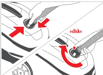
Raccordez le flexible d'aspiration à l'appareil.
