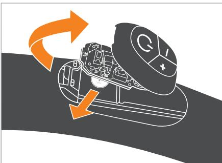
**Remplacement de la pile de la télécommande de la poignée du flexible d'aspiration** (peut varier selon les modèles)
